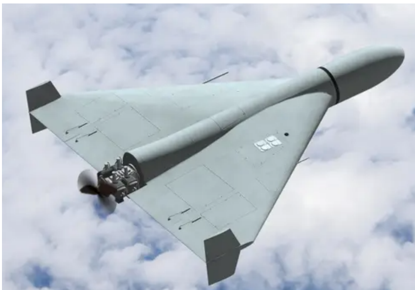
Рисунок І.11. Ударний БПЛА типу “Shahed-136”/“Герань-2” з 4-елементной антенной “Комета”
