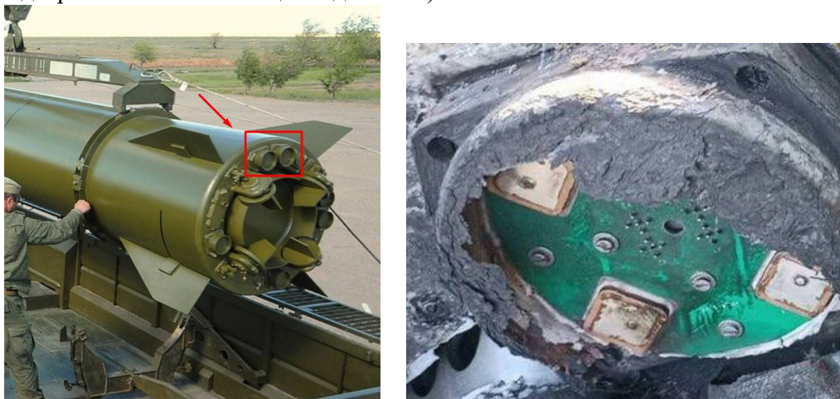
Рисунок I.10. CRPA антени «Комета Р8», які встановлений у ракеті «Іскандер»
